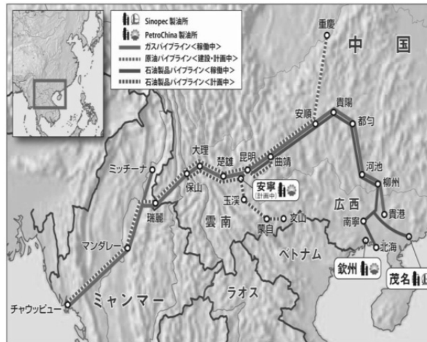
図13 ミャンマー経由の原油と天然ガスの輸入パイプライン
